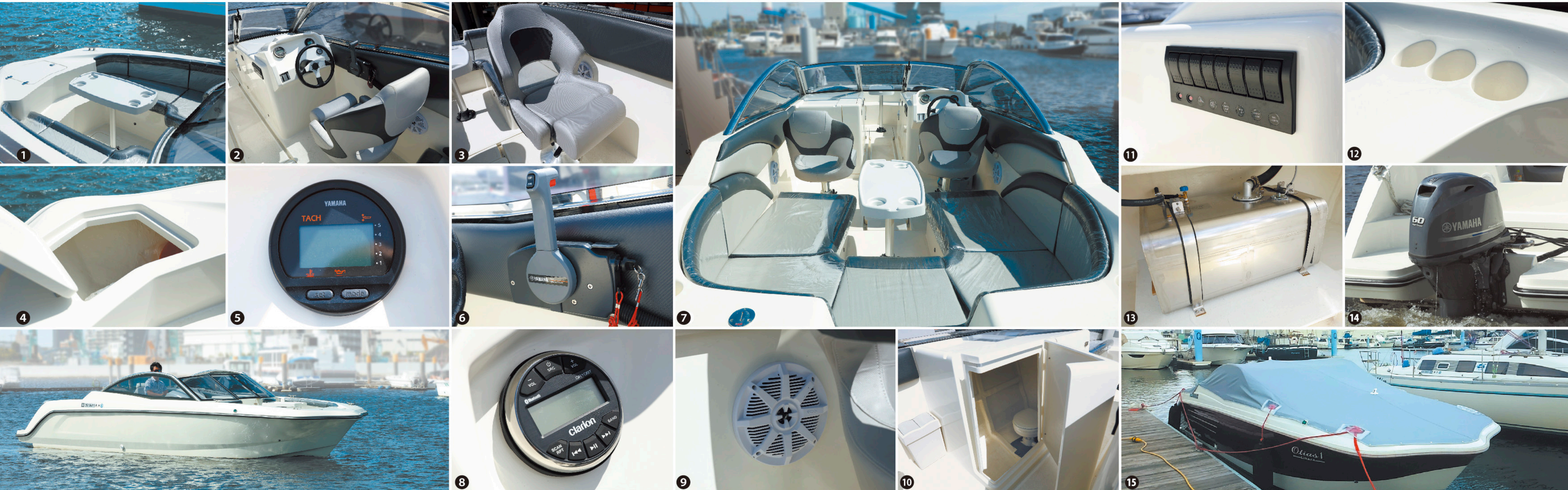
①バウ側シート ②運転席 ③助手席シート ④バウハッチ ⑤メーター ⑥コントロールレバー ⑦リアシート ⑧マリンオーディオ ⑨防水スピーカー ⑩トイレ ⑪電気スイッチパネル ⑫ドリンクホルダー ⑬燃料タンク ⑭船外機 ⑮船体カバー(オプション) ※オプション:船底塗装
