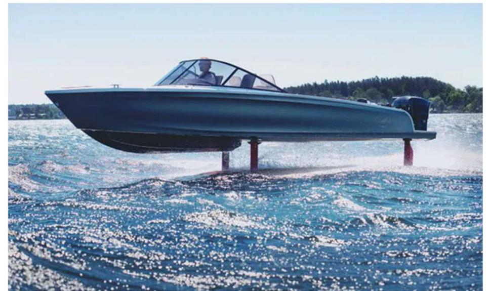
低抵抗で高速・低電力の水中翼船
