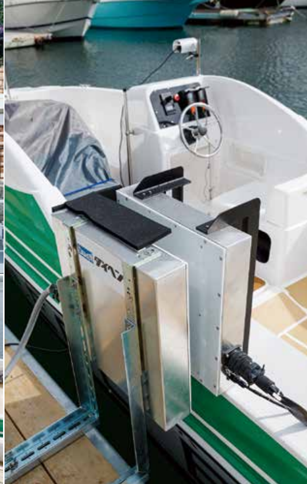
ベース基地となる台船上の建屋の天井に8kW/hの太陽光パネルを設置、デッキ上の12kW/h蓄電池に充電する。エレクトリックボートへの電源供給は、ダイヘン社製の非接触型3kW/h電源を使用。
