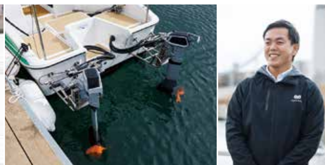
リチウムイオンバッテリーと電動船外機2基を搭載し、センサーとAIにより障害物を避け自律航行する「ECO BOAT」。開発にあたった「エイトノット」代表の木村裕人氏は「まだまだ課題は多い」と語るが、目を見張るような革新技術が満載されたボートは未来を見据えたものだ。
