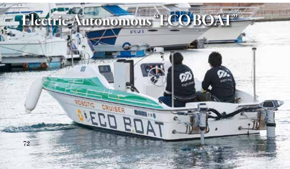
リチウムイオンバッテリーと電動船外機2基を搭載し、センサーとAIにより障害物を避け自律航行する「ECO BOAT」。開発にあたった「エイトノット」代表の木村裕人氏は「まだまだ課題は多い」と語るが、目を見張るような革新技術が満載されたボートは未来を見据えたものだ。
