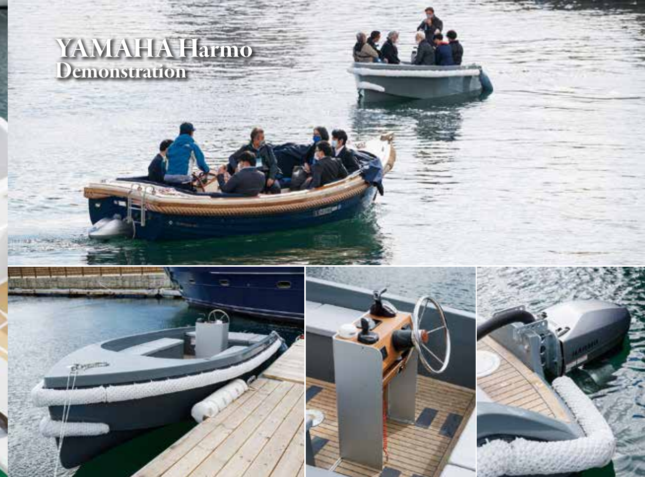
ヤマハ発動機が開発した次世代の電動操船システム「Harmo (ハルモ)」のデモンストレーションも行われた。ジョイスティック操船により狭小水域でのその場回頭などを容易にしたHarmoは、河川や運河環境の多いヨーロッパでの普及が期待されている。グレーの艇体はデンマークのエレクトリックボート「RAND PICNIC 18」、ネイビーの艇体はオランダのEnkhuizenloopが製造する「Enkhuizen 645」にそれぞれHarmoを搭載。
